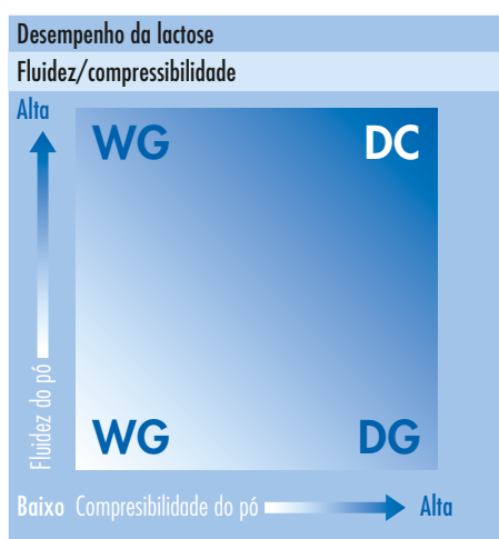
Figura 1: Exigências de fluidez e compressibilidade da mistura de pó para diversas tecnologias de produção de comprimidos (DC é compressão direta, WG é granulação úmida e DG é granulação seca) [3].
