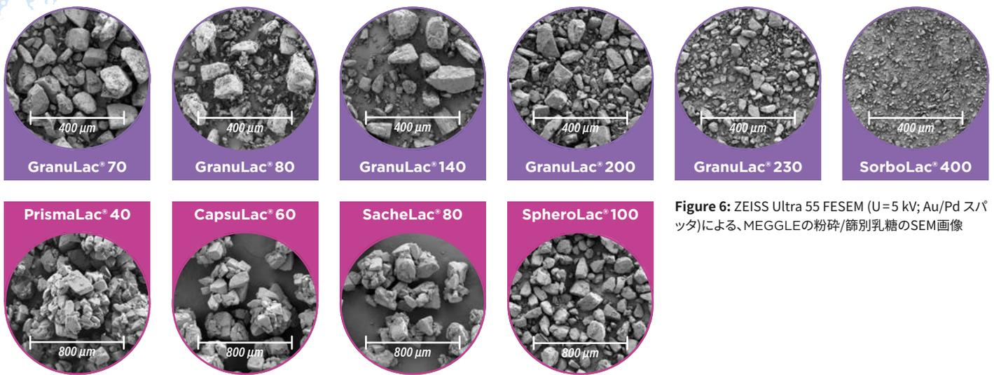
Figure 6: ZEISS Ultra 55 FESEM (U=5 kV; Au/Pd スパッタ)による、MEGGLEの粉碎/篩別乳糖のSEM画像
