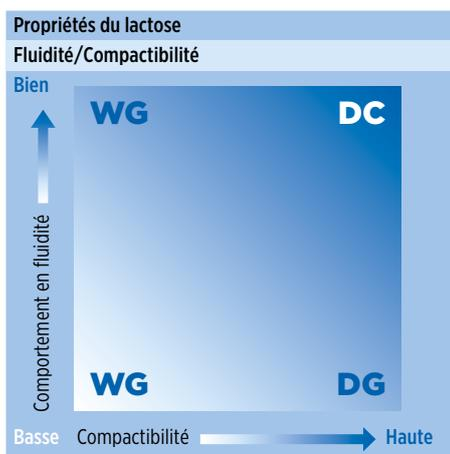
**Image 1 :** exigences envers la fluidité et la compactibilité d'un mélange de poudres pour diverses techniques de compression (DC = compression directe, WG = granulation humide, DG = granulation sèche) [3].
