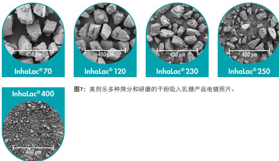
图7：美剂乐多种筛分和研磨的干粉吸入乳糖产品电镜照片。
