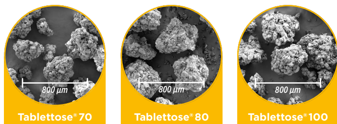
Рисунок 6: Снимки агломерированных лактоз MEGGLE, сделанные с помощью РЭМа ZEISS Ultra55 FESEM (U=5 kV; Au/Pd напыление).
