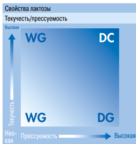
Рисунок 1: Требования к текучести и прессуемости порошков для различных технологий таблетирования (DC – прямое прессование, WG – влажная грануляция, DG – сухая грануляция) [3].
