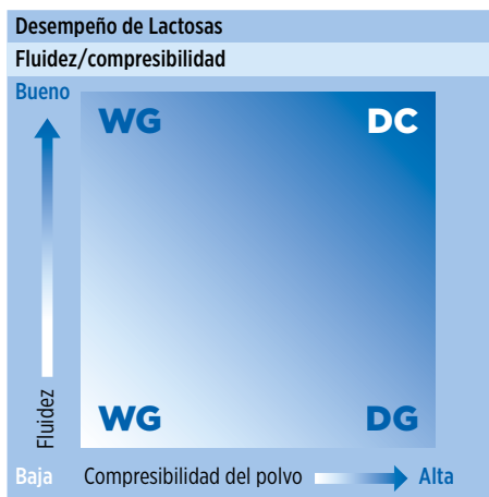
Figura 1: Requerimientos de compresibilidad y fluidez para diferentes tecnologías de comprimidos (DC es compresión directa, WG es granulación húmeda, DG es granulación en seco) [3].
