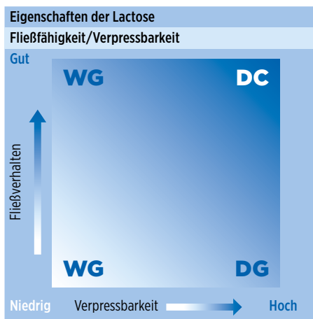
Abbildung 1: Anforderungen an Fließverhalten und Verpressbarkeit einer Pulvermischung unter Berücksichtigung verschiedener Tablettiertechniken. (DC = Direkttablettierung, WG = Nassgranulierung, DG = Trockengranulierung) [3].
