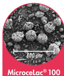
Abbildung 6: REM-Aufnahme von MicroceLac® 100.
