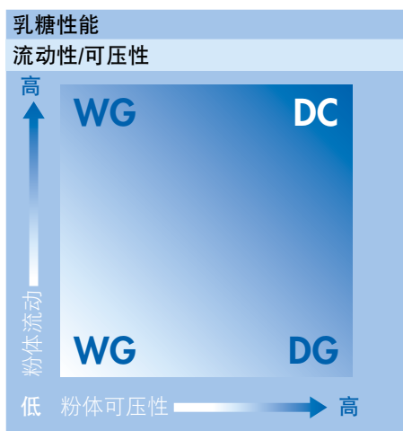
图1：各种压片技术对混合粉末可压性和流动性要求 (DC-直接压片，WG-湿法制粒，DG-干法制粒) [3]。
