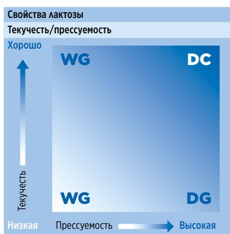
**Рисунок 1:** Требования к текучести и прессуемости порошков для различных технологических процессов.
