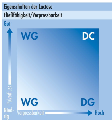
Abbildung 1: Anforderungen an Fließverhalten und Verpressbarkeit einer Pulvermischung unter Berücksichtigung verschiedener Tablettiertechniken. (DC = Direkt-Tablettierung, WG = Nassgranulierung, DG = Trockengranulierung) [3].
